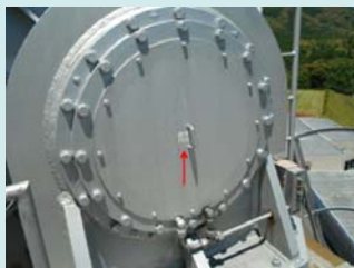
図3. 第二アンテナのEL軸上部分に取り付けた標的。「取っ手」が邪魔で、左側にずれて取り付けられている。
