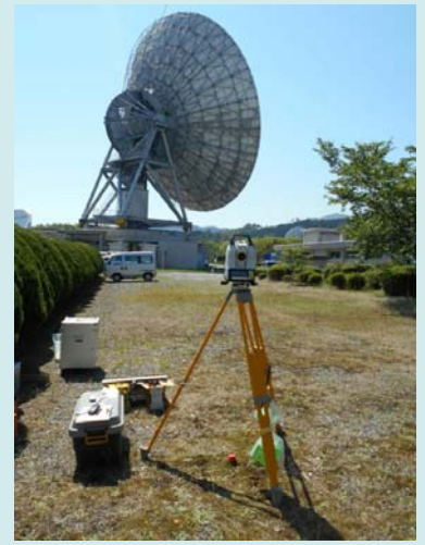
上: 図4. 観測点1に設置した標識。
