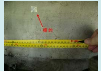
図7. Az軸受けの周囲長(半径)の測定。
