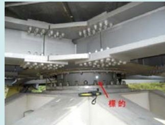
図6. Az軸受け部に取り付けた標的。(写真は茨城局での測定時のもの)
