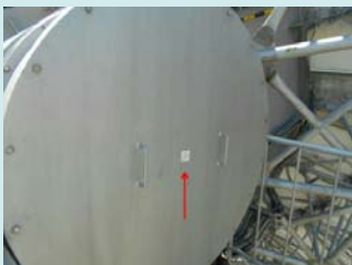
図2. 第一アンテナのEL軸上と思われる部分に取り付けた標的。
