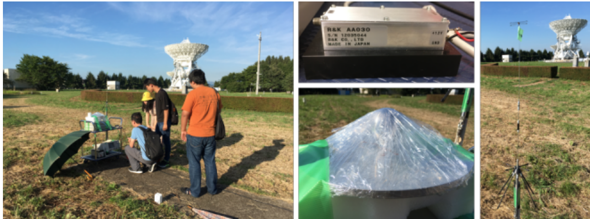
図 1 水沢局内における 2018 年 8 月 23 日の測定の様子と測定系 (増幅器, 涙滴アンテナ, およびディスクコーンアンテナ)。中国科学技術大学の学生 3 人と総研大生 1 人とともに測定を行った。奥には水沢 20 m & 10 m アンテナが見える。地上での測定であり、周囲には建物や樹木が多く見通しは良くはない。
