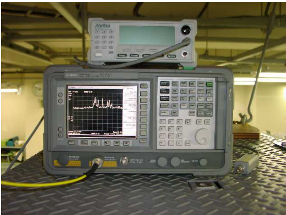
図2. 足場上でのスペアナによる測定の様子 黄色ケーブル1本だけを使った。W49Nのスペクトルが見えている。
