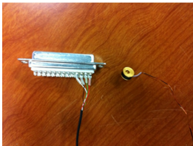
図 32 デューワー内温度測定用ケーブル
