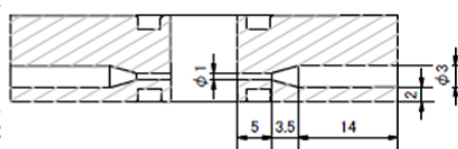
アイフランジ側面の図面
