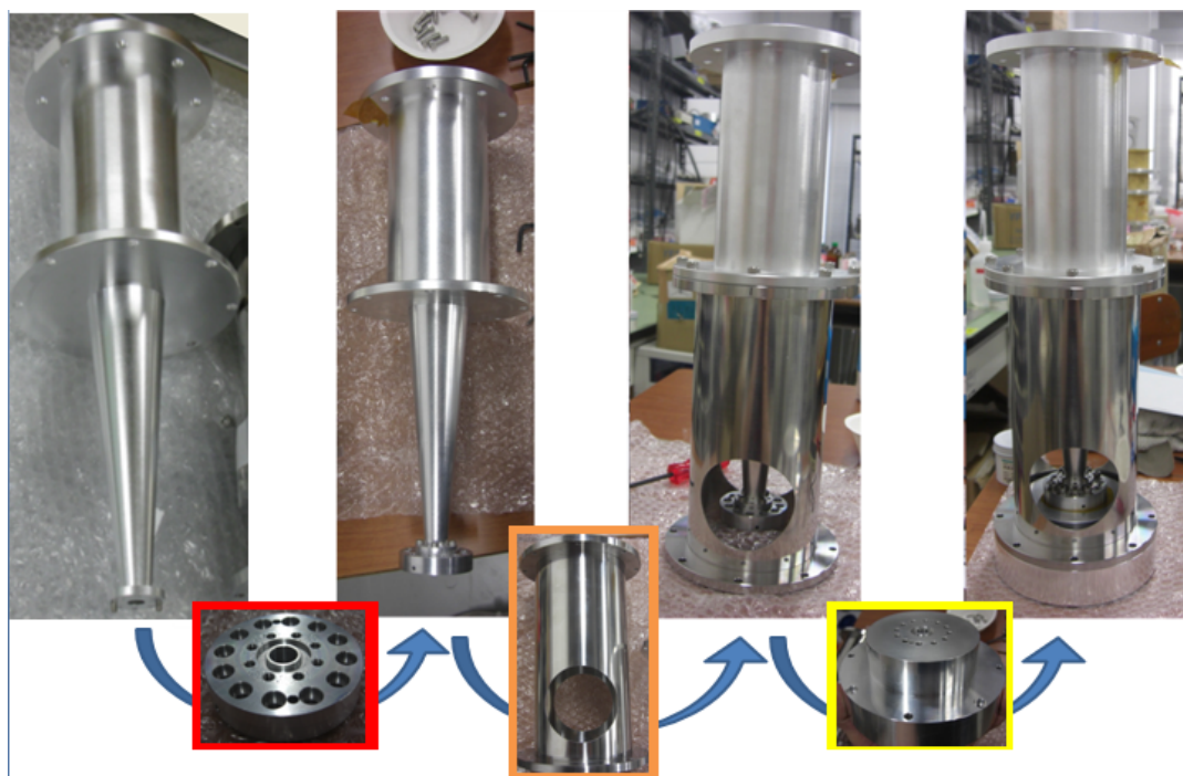
図 18 デュワー上部の全体構造
