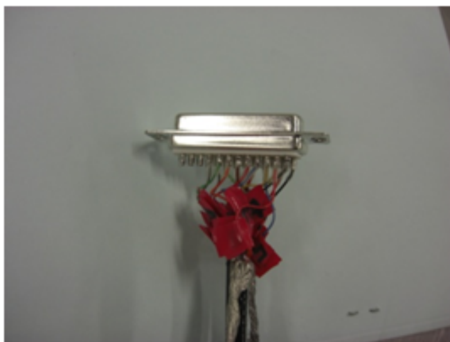
図 23 作成したバイアス用ケーブル（デュワー外側）
