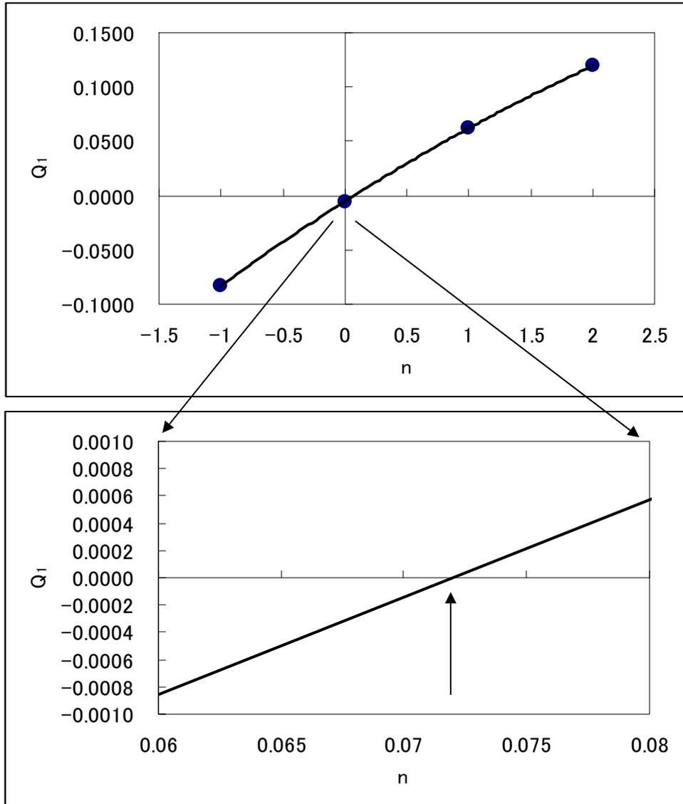
図13.  $Q$ が0となる瞬間を読み取る。上：全体図、下： $Q_1 = 0$ 付近の拡大図。
