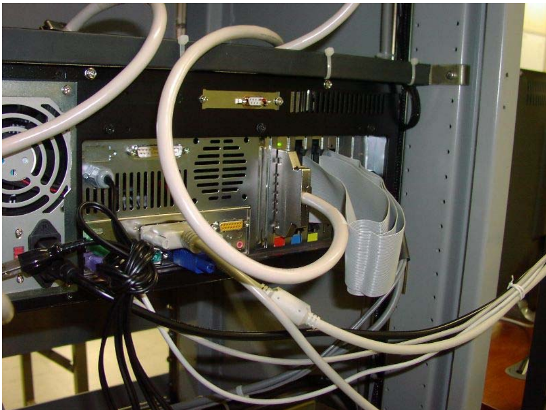
図 4. 追尾システム用PCの角度読み込み用P I Oボードへの新ケーブルの接続
