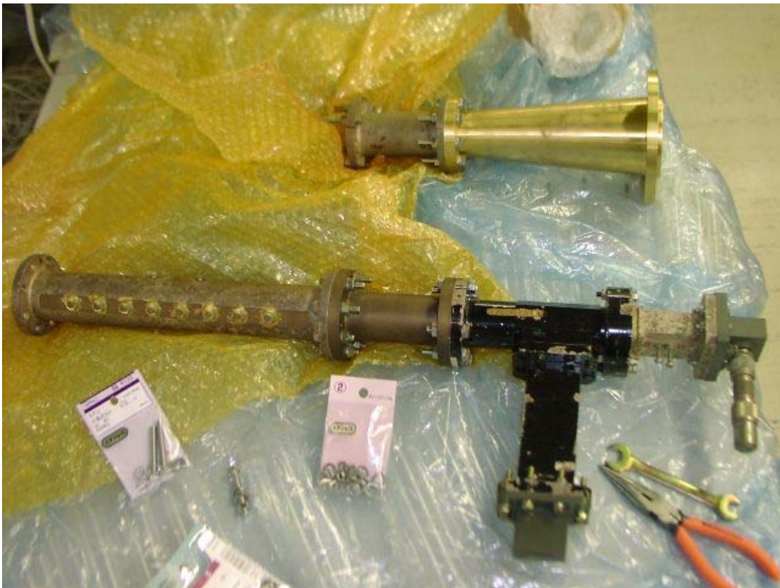
図2. 6. 7 GHz 受信用給電部写真
