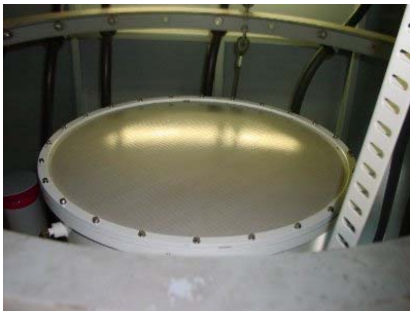
図 2 a. ホーン上部 室内に位置するため、きれいな状態に保たれている。
