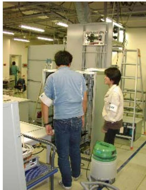
(左) ケーブルの位置を変更：受信機に干渉しないよう、アンテナへつながるケーブルの配置を変更した。
