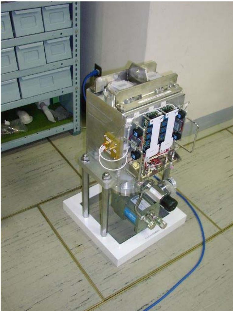
(左) 今回設置した受信機：下の白枠は部屋内に置くための台、上部には吊り下げるための取っ手が着いている。これらは設置時には取り外す。
