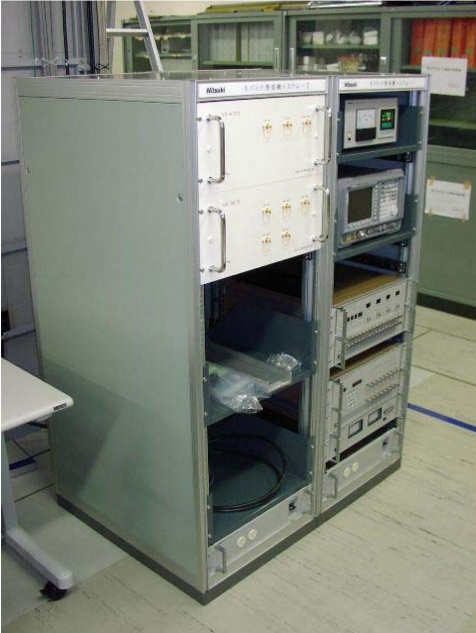
完成したラック：奥の最上段から受信機モニタ（温度・圧力）、汎用の台（スペアナを設置）、K-4 ビデオコンバータ。手前の上段から6.7GHz ダウンコンバータ、8GHz ダウンコンバータ。その下は大きくあいている。奥は機器を止める穴のピッチがJIS（EIJ）規格、手前はインチになっている。今後、手前もJISに変更する予定。
