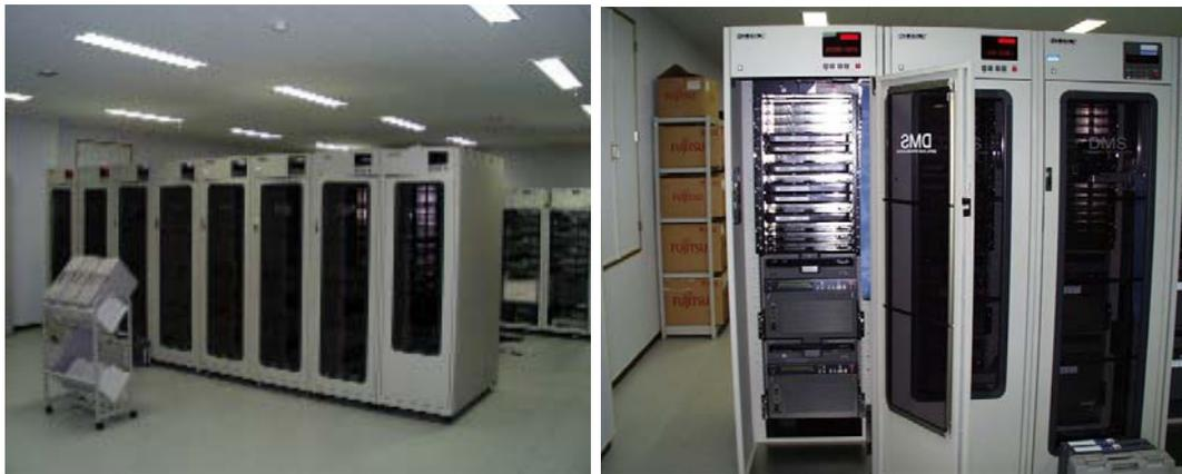
Figure 4.51: 三鷹相関局に設置された再生装置 (左) 8 台のカセット交換機 (右) 各カセット交換機には、2 台の DIR-1000 または DIR-2000 と、16 巻のカセットテープを格納できる。
