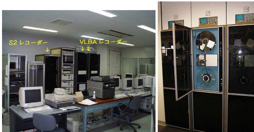
Figure 4.52: (左) 三鷹相関局に設置された S2 および VLBA 記録装置 (右) VLBA 記録装置
