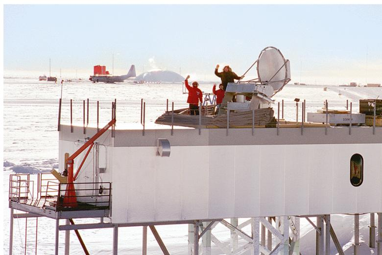
Figure 2.6: 南極に設置された、口径 1.7m のサブミリ波アンテナ。高ゲインを得るためにオフセットパラボラとなっている。
