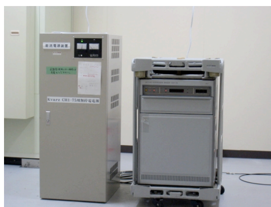
図6. 水素レーザー装置と無停電電源
