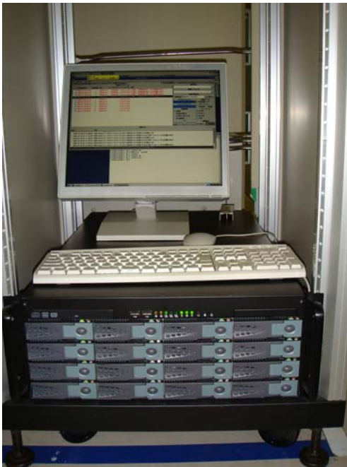
図 1: 山口局に新規に導入した K5/VSI 2号機 (PC の前面カバーを外した状態)。16 台のハードディスクで RAID を構成している。
