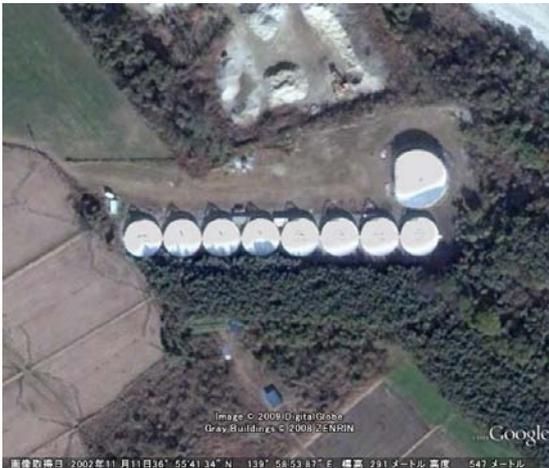
図 1. 上空 300m から見た那須パルサー観測所。東西に 8 台並んでいるのが 20m 固定球面鏡。第二列目として 30m 鏡（右上の大きいアンテナ）も 1 台完成している。(Google Earth より)
